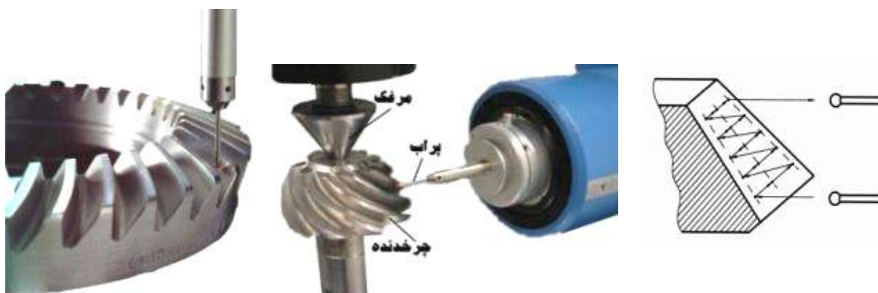
نحوه‌ی کنترل سطح دندانه هنگام اندازه‌گیری چرخنده
