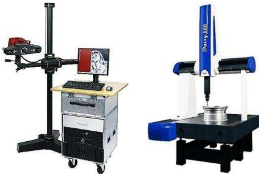
شکل ۱-۱۱- دستگاه اندازه گیری مختصات (CMM) نوع تماسی (راست) و نوع غیر تماسی (چپ)
