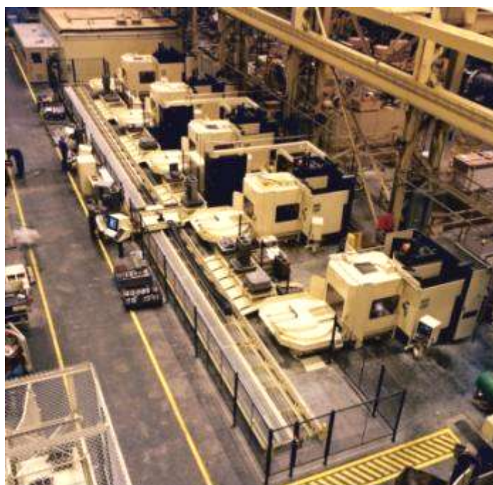
شکل ۱-۹- یک نمونه FMS با ۵ ماشین ابزار در شرکت Cincinnati
