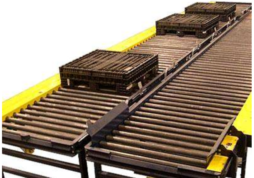
شکل ۱-۱۴- کانوایرهای انتقال مواد خام و قطعات (نوع غلتکی ثقلی)
