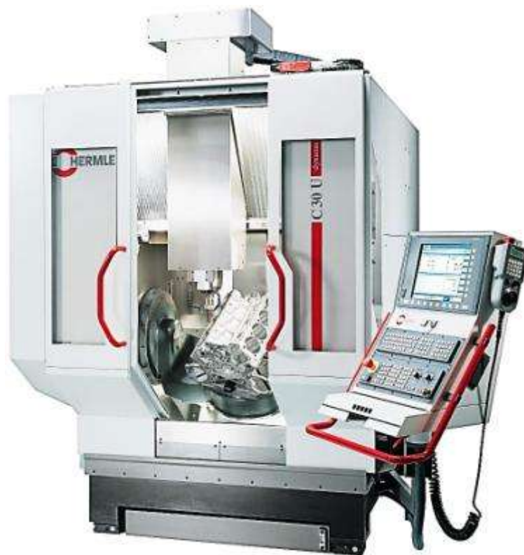
شکل ۳-۱- ماشین فرز CNC در حال ماشینکاری پوسته موتور
