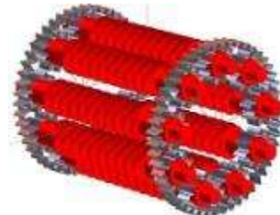
شکل ۳-۱۳- استفاده از چرخدنده خورشیدی بمنظور ایجاد همزمانی حرکت غلطک های پیچ غلطکی
