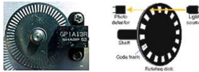
شکل ۳-۲۴- یک نمونه از انکودرهای دورانی ساده
