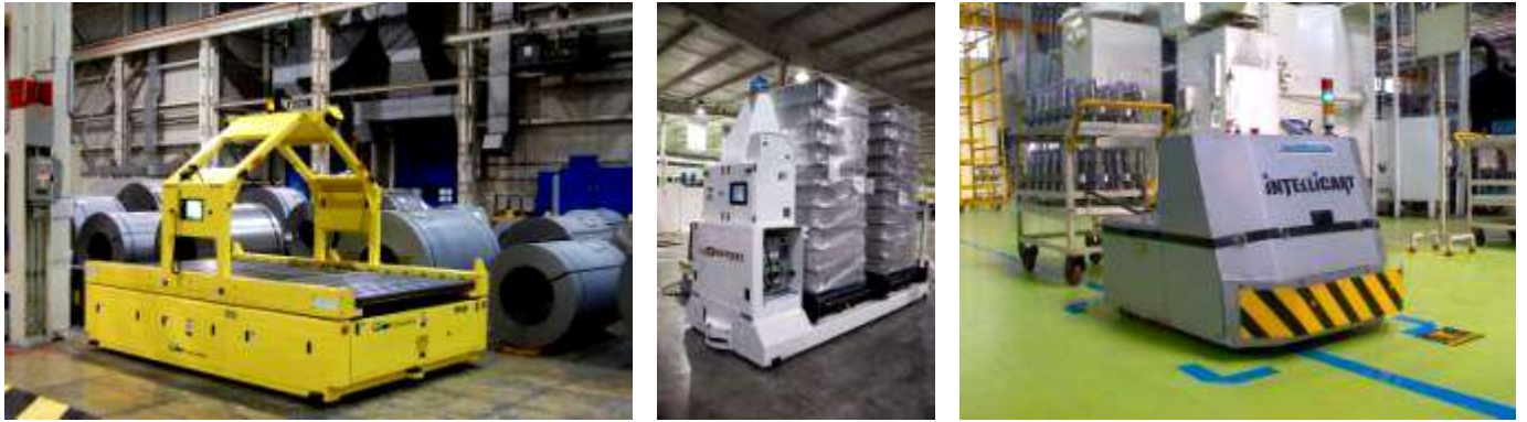
شکل ۱-۱۰- دو نمونه AGV (سمت راست خط یاب، وسطی لیزری)
