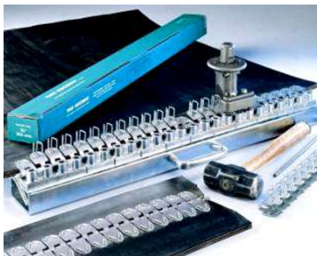
نمونه ابزارآلات اتصال مکانیکی تسمه های تخت
