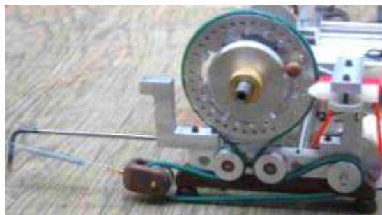
یک نمونه کاربرد تسمه های گرد
