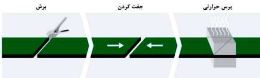
مراحل اتصال تسمه تخت به روش ذوبی
