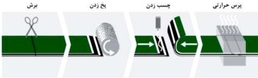
مراحل اتصال تسمه تخت به روش چسب زنی
