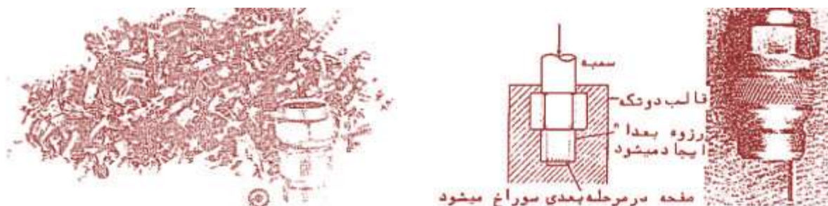
شکل ۱-۳۶ - تولید بدنه شمع اتومبیل (اول سمت راست) به روش شکل دادن سرد (دوم سمت راست) بدنه شمع پیش از ایجاد رزوه، (سمت چپ) براده حاصله هنگام تهیه شمع بوسیله ماشینکاری. قطعه کوچک گرد تنها ضایعه فرآیند شکل دادن سرد است.
