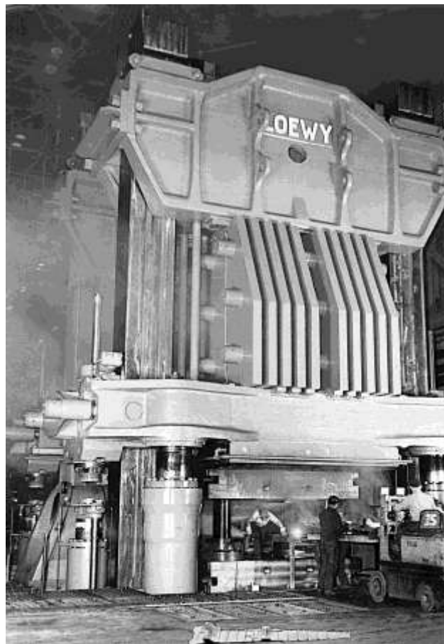
شکل ۱-۱۵- پرس فورجینگ ۵۰۰۰۰ تنی و قطعه آلومینیومی ۱۲۱ اینچی (۳متری) به وزن ۲۶۲ پوند (۱۱۹ kg) تهیه شده با این پرس
