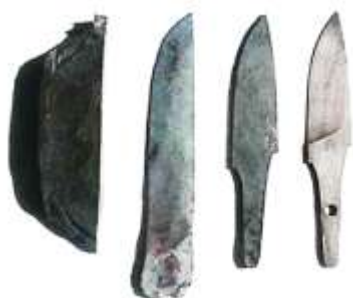
شکل ۱-۱- شکل دهی فلز با استفاده از روش فورج، قطعه ی فلز به تدریج در اثر ضربه شکل تیغه را به خود گرفته است.
