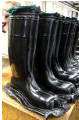
پوتین های لاستیکی تولید شده به روش قالبگیری فشاری
