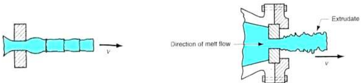
تصویر سمت راست عیب پوسته کوسه ای شدن ( Sharkskin ) و تصویر سمت چپ بامبوای شدن ( Bambooning )
